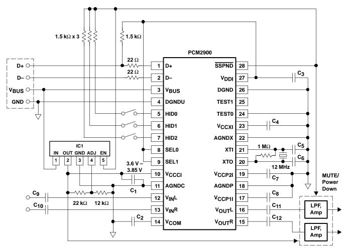
NOTE:  $C_1, C_2: 10 \,\mu\text{F}$
